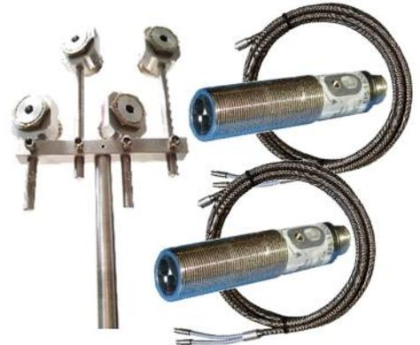
Der vielfach verstellbare Ausleger nimmt die Faseroptiken von zwei parallelen Sensoren auf, die im V-Prinzip zueinander ausgerichtet werden. Im Normalzustand wird nur der innere Sensor bedämpft („1“) und der äußere ist frei („0“). Schaltet der äußere Sensor auf „1“ muss die Bahn nach innen gesteuert werden, schaltet der innere Sensor auf „0“ nach außen.
